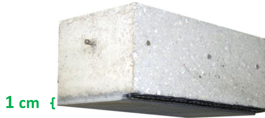
Foto: Verstärkung mit Carbonbeton (© TU Dresden)
