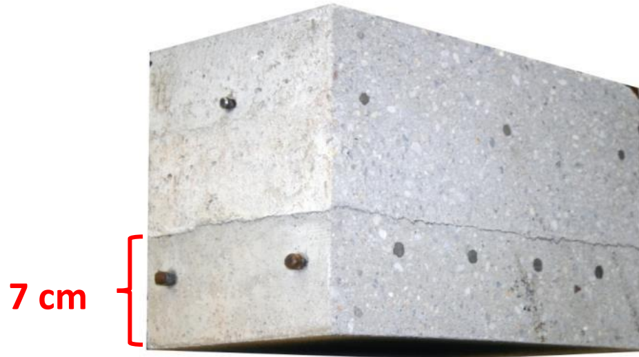
Foto: konventionelle Spritzbetonverstärkung (© TU Dresden)
