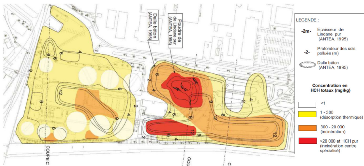
Abbildung 4: Verteilung der HCH Belastung im Untergrund
