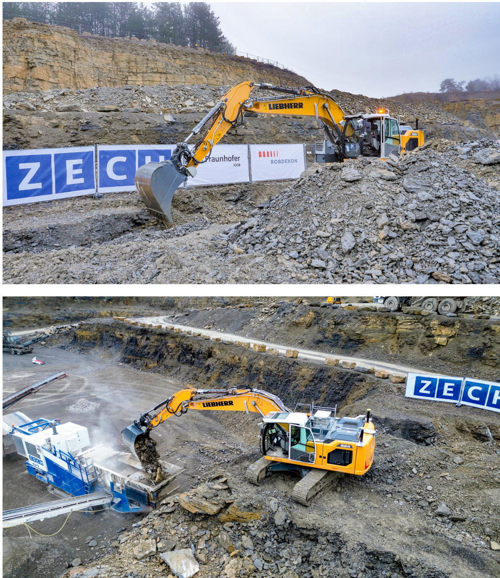
Abbildung 3: Pilotprojekt mit autonomem Bagger im Steinbruch. Autonomer Aushub des Materials (oben). Autonomes Beschicken des Steinbrechers (unten).
