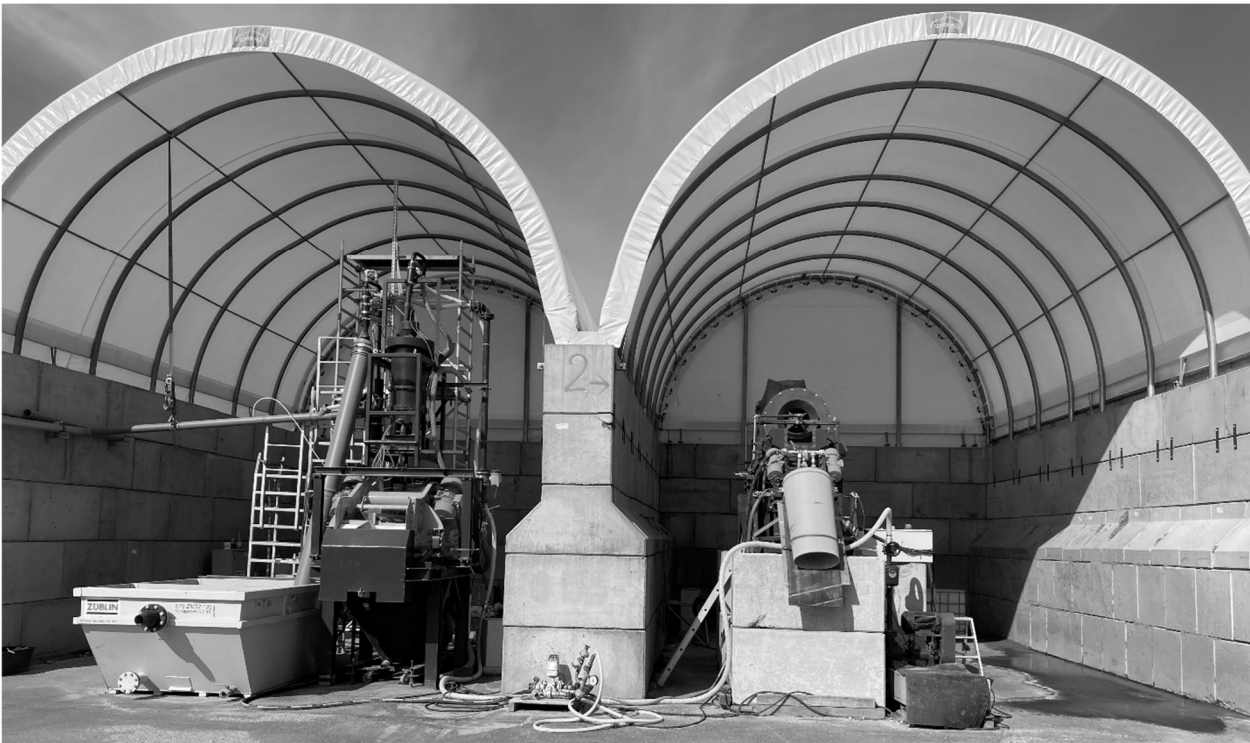
Abbildung 2: Technikumsanlage für Bodenwaschversuche.
