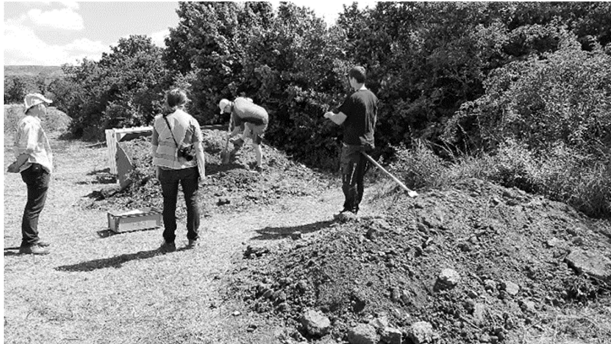
Abb. 1: Ringversuchsaufbau mit Haufwerk aus einer ausgekippten Radladerschaufel (vorne) und einer befüllten Radladerschaufel (hinten, während der Beprobung)
