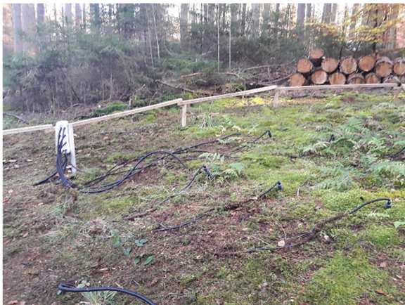
Abbildung 2: eingebaute FDR-Sonden im Messfeld der offenen Baumweise in Baltmannsweiler; eigene Aufnahme
