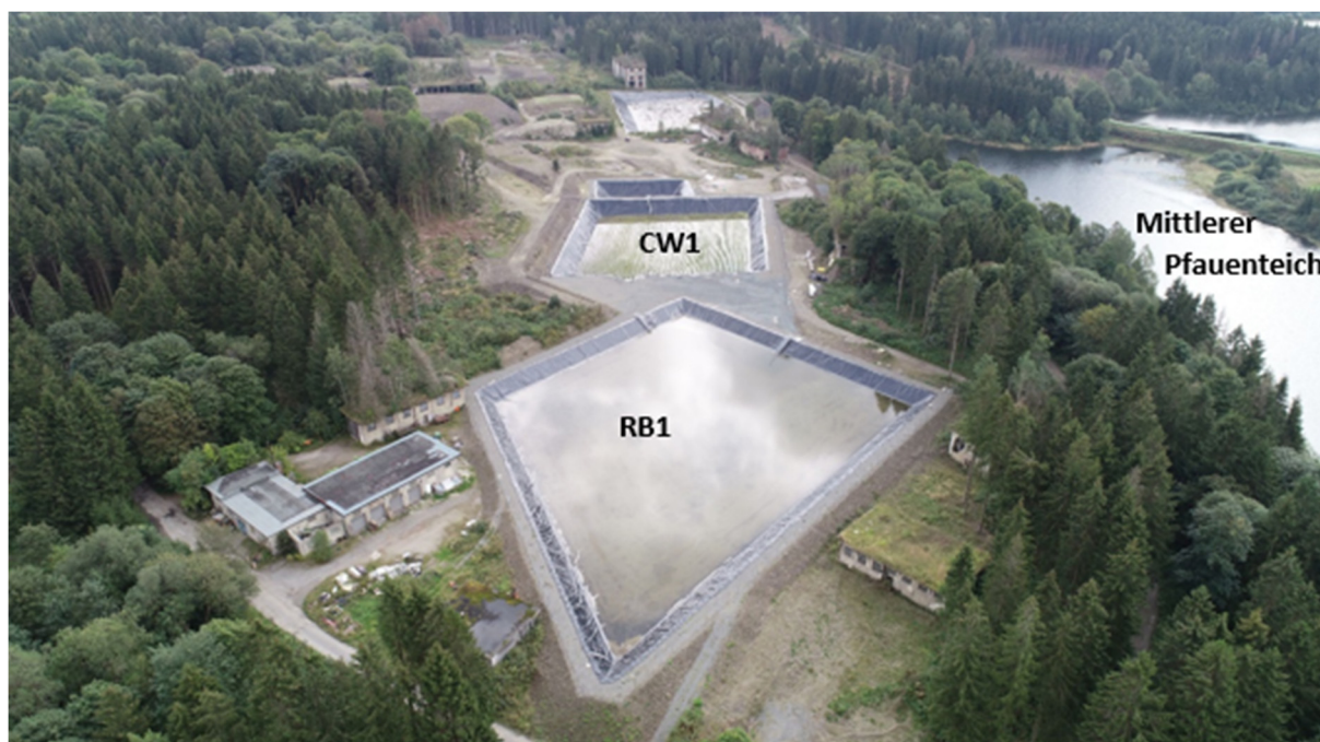
Abb. 6: Drohnensicht der Anlage im September 2021: im Vordergrund Rohwasserbecken 1, Bildmitte Wetland 1, kleines Becken dahinter Sedimentationsbecken 1; (Quelle: Landkreis Goslar)
