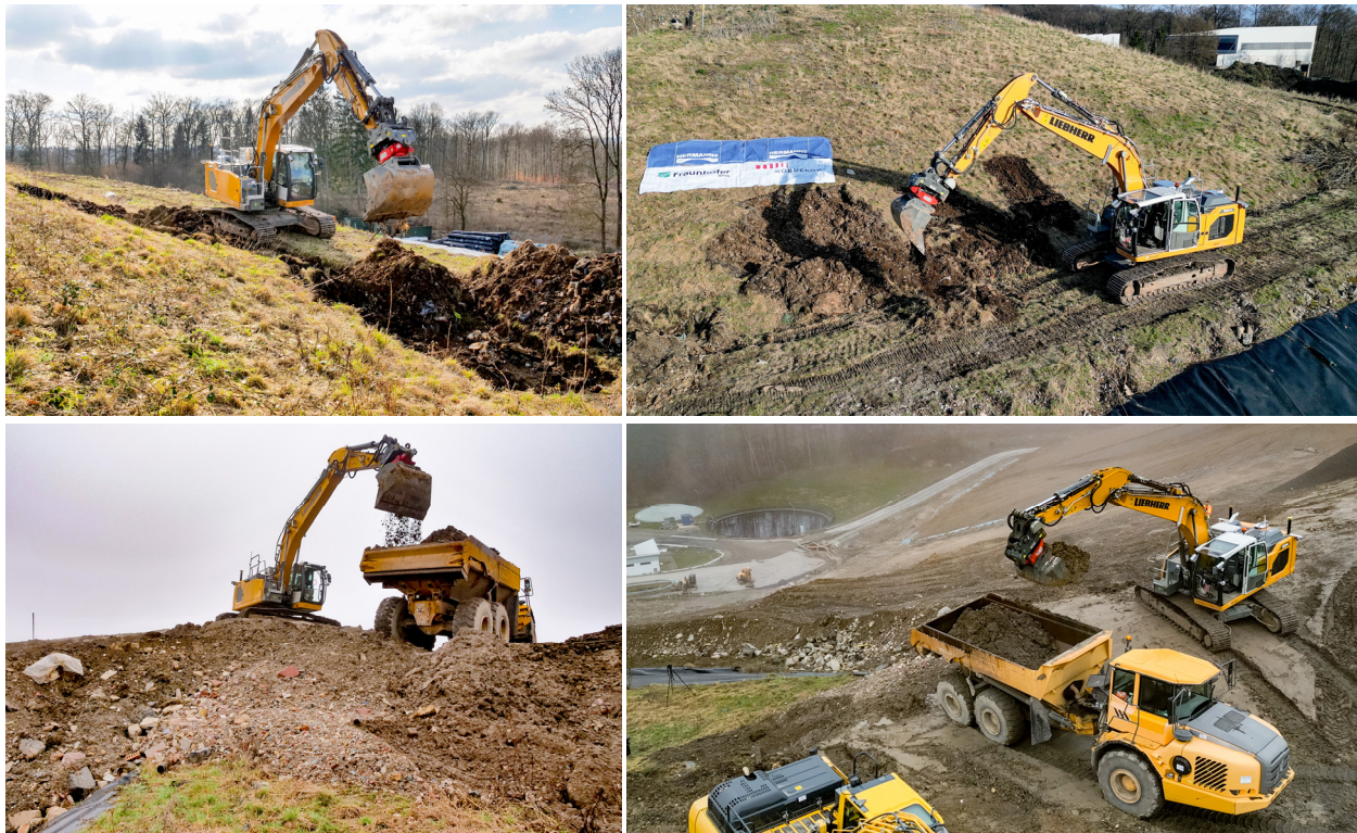
Abbildung 4: Autonomer Bagger auf Mülldeponie. Autonome Erledigung von Grabeaufgaben am Hang (oben). Beladen eines gewöhnlichen Transportfahrzeugs (unten).
