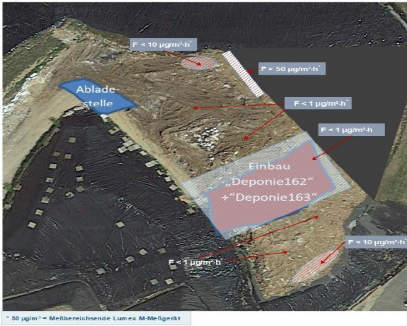
Abbildung 7: Hg 0 -Emissionsprofil – aktive Einlagerungsfläche von 3000 m 2
