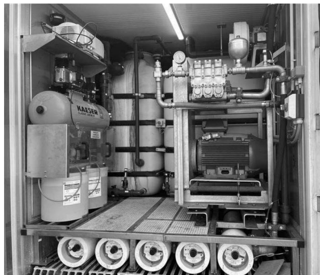
Abbildung 3: Umkehrosmose-Container mit verschiedenen Durchsatzleistungen
