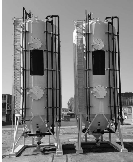
Abbildung 2: Mobile Aktivkohle-Behälter für den flexiblen Einsatz
