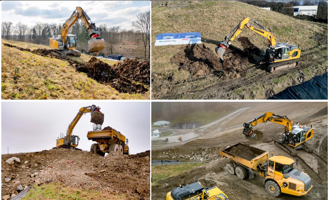
Abbildung 10: Autonomer Bagger auf Mülldeponie. Arbeiten am Hang (oben) und Beladen eines gewöhnlichen Transportfahrzeugs (unten) erzeugen realistische Eingabedaten für das KI-Modell.
