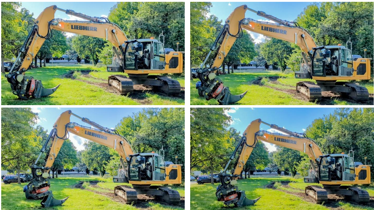
Abbildung 16: Autonomes Abkoppeln eines Werkzeugs (Reißzahn): Ablegen und Entriegeln, Ausdrehen, Arm vom Werkzeug lösen
