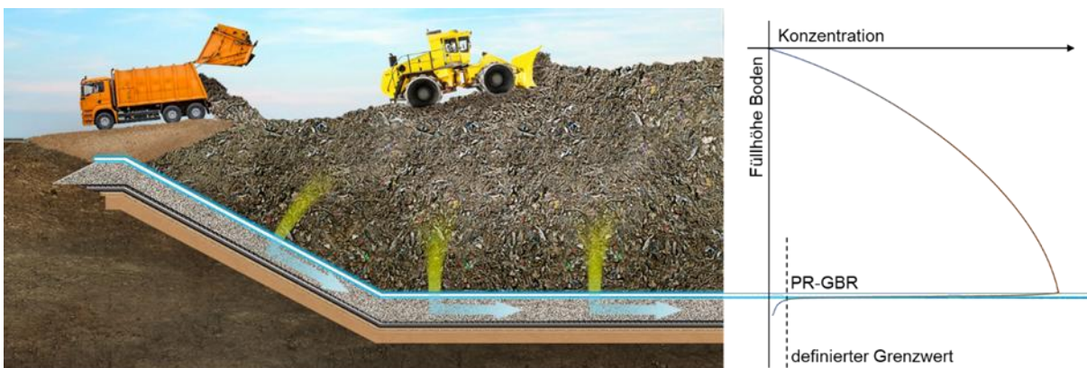
Abbildung 5: Schematische Darstellung in-situ Sickerwasserbarriere oberhalb der Basisabdichtung und Schadstoffanreicherungskurve (Niewerth, 2021)
