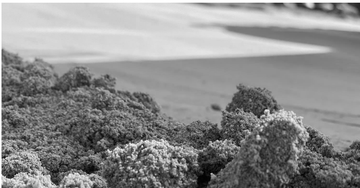
Abbildung 32: Detailaufnahme von lockerem Trisoplast®, Quelle: G quadrat GmbH
