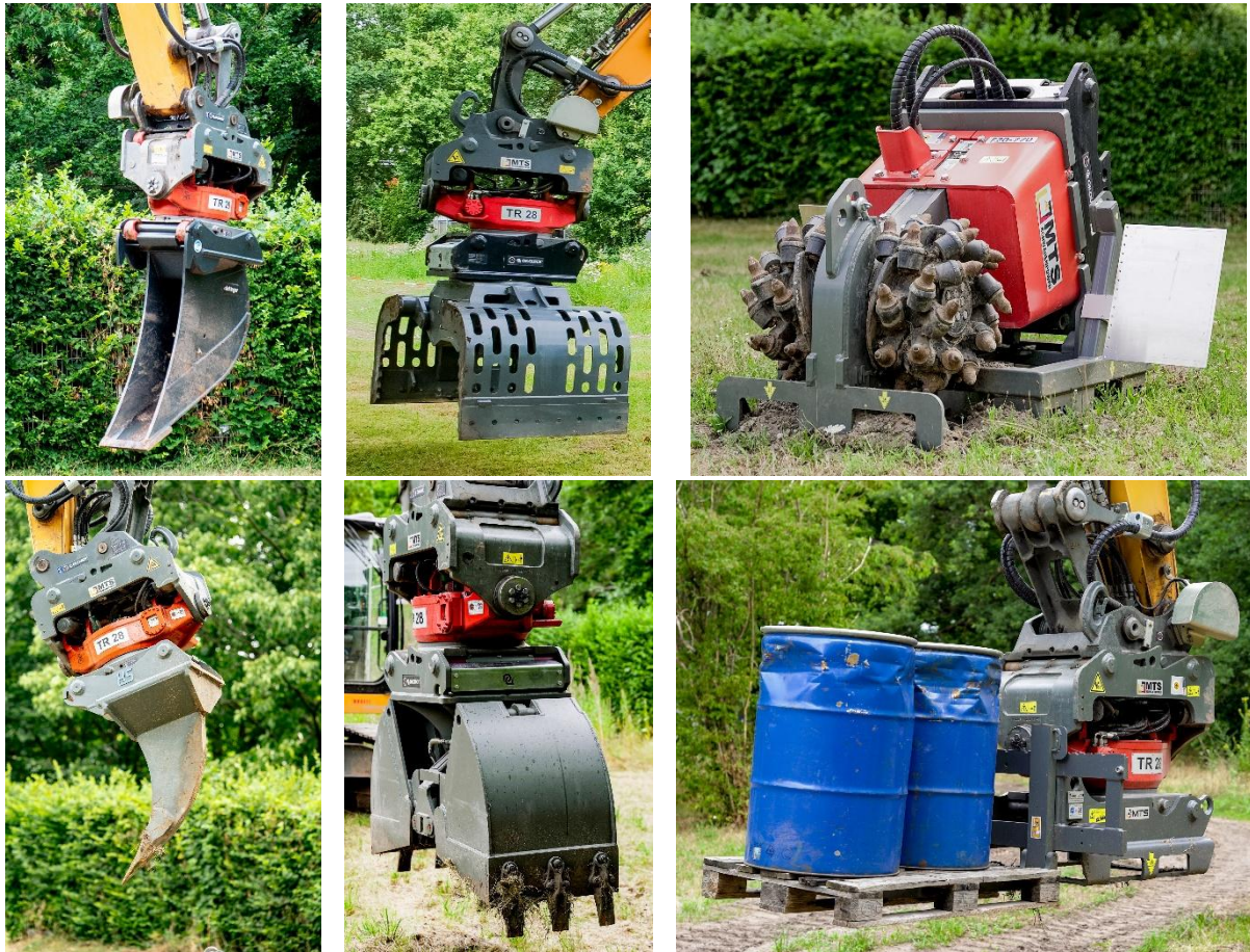
Abbildung 14: Anbaugeräte für den IOSB-Bagger ALICE: Oben: schmaler Löffel, Sortiergreifer, Felsfräse; Unten: Reißzahn, Zweischalengreifer, Palettengabel
