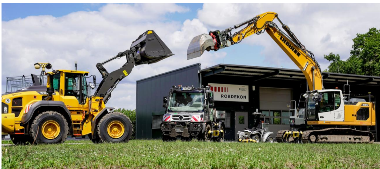
Abbildung 6: Autonome Arbeitsmaschinen am Fraunhofer IOSB. Neu hinzugekommen ist der Radlader Volvo L120H (links). Mittig ist der Unimog LUCI zu sehen, im Vordergrund rechts davon drei Spot-Roboter, im Hintergrund ein kleines Vierradfahrzeug IOSB.Q2 und ganz rechts der Bagger ALICE.
